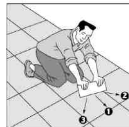
Etap 1.: wygładzanie ręczne
